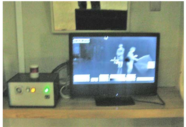
駐車場側入口をモニターとアラームユニットで監視 発熱者が通るとアラーム音・パトライトが点灯
